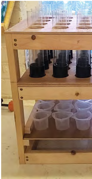
Montaje de las columnas de suelo
