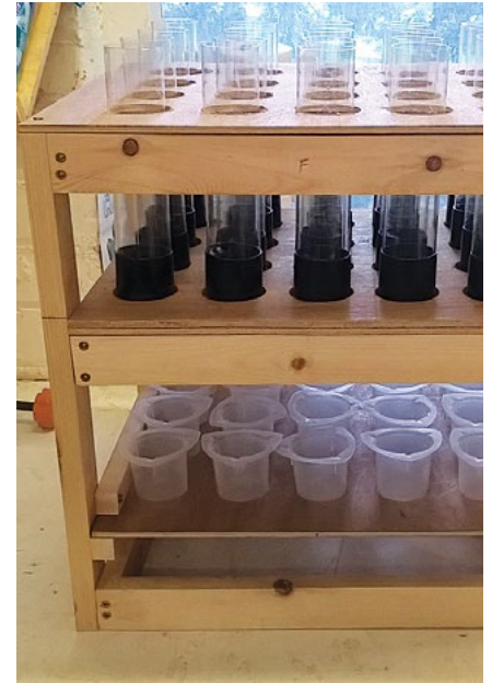
Montaje de las columnas de suelo
