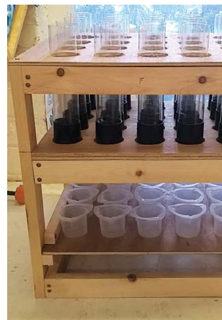
Colunas de lixiviação com coletores
